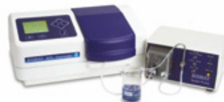
Pour des applications moins sensibles et dotées d'une place de longueur d'onde plus importante, sélectionner le modèle 6270. Choisir le modèle 6280 pour obtenir les déterminations les plus sensibles, avec des longueurs d'onde d'émission allant jusqu'à 650 nm. Pour des longueurs d'onde d'émission plus élevées, sélectionner le modèle 6285, doté d'un détecteur infrarouge amélioré.
