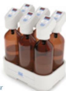
L'instrument constitue une solution complète pour l'utilisateur. Il est immédiatement opérationnel pour la mesure de DBO sur quatre échelles : 90 ppm, 250 ppm, 600 ppm et 999 ppm. La quantité d'échantillon à examiner varie entre 100 mL et 400 mL, la capacité totale du flacon étant de 500 mL.
